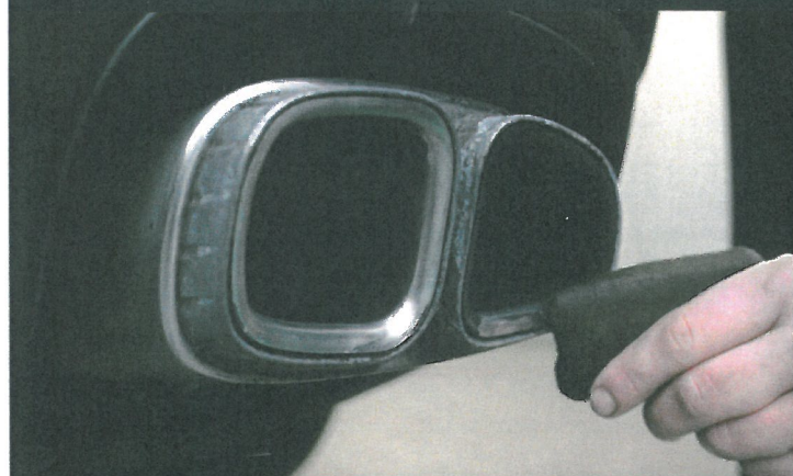
Reinigung der Endrohre
